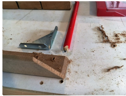
MDF profiel voor de 4 zijden. Gegalvaniseerd lichtmetalen profiel voor hoeken.
