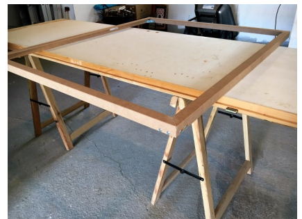
Na eenzelfde werkwijze van de montage van de 4 hoeken is het geraamte klaar.
